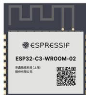
Das ESP32-C3 Modul basiert auf einem RISC-V Einkernprozessor mit maximaler Taktfrequenz von 160 MHz und verfügt über on-chip 400 KB SRAM und 384 KB ROM. Als periphere Memory Schnittstellen stehen Dual SPI, Quad SPI und ein QPI Interface zur Verfügung, welches eine direkte Verbindung zu einem externen Serial Flash Speicher ermöglicht. Leistungs- und HF Performance entsprechen dem Stand der Technik
