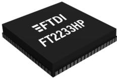
FTDI Chip hat eine Familie von sechs neuen USB-to-UART / MPSSE (Multi Protocol Synchronous Serial Engine, SPI/I2C/JTAG master) Brückenbausteine der Reihe FT223xHP, mit implementiertem Typ C Versorgungsspannungskontroller vorgestellt. Die USB Typ C high speed Brückenbausteine verfügen über eine Spannungsversorgung nach PD 3.0
