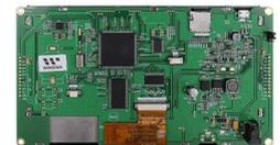
Die 7" IPS M-Serie verfügt **wahlweise über einrsistives oder ein kapazitives PTC Touchpanel**. Das Modul WF70MTABHLRN0 ist mit einem STM32F429 Mikrocontroller (CPU-Frequenz 180MHZ) ausgestattet.
